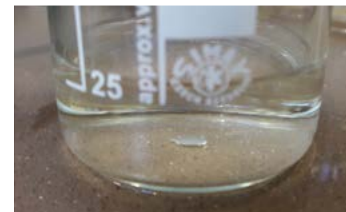
Figura 17. Solución de 0,286 g del posible meteorito chino luego de haber agregado 1 mL de Dimetilglioxima y no haber tenido cambio en la tonalidad. Negativo para níquel y para meteorito.
